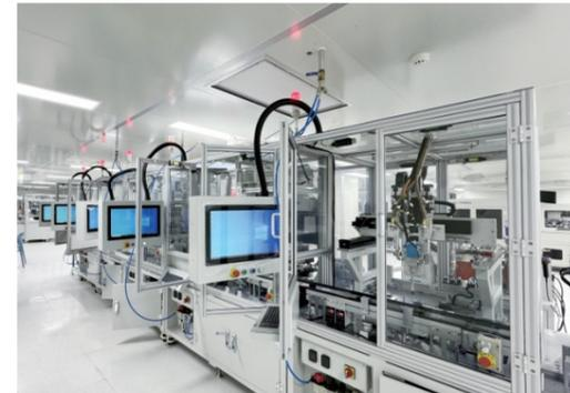
符合ISO14644标准的10万级洁净车间, 拥有IATF16949体系, 产品线覆盖车规级传感器: 单轴/三轴加速度传感器、高度传感器和扭矩角度传感器等; 控制器等。
